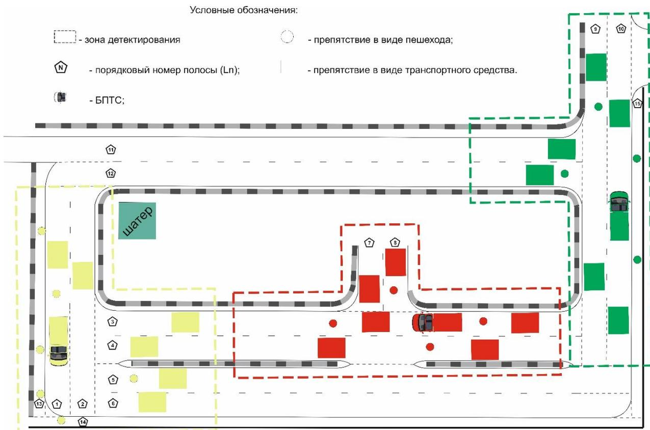
Рисунок 2 – Месторасположение зон для оценки функционирования системы детекции и распознавания препятствий
