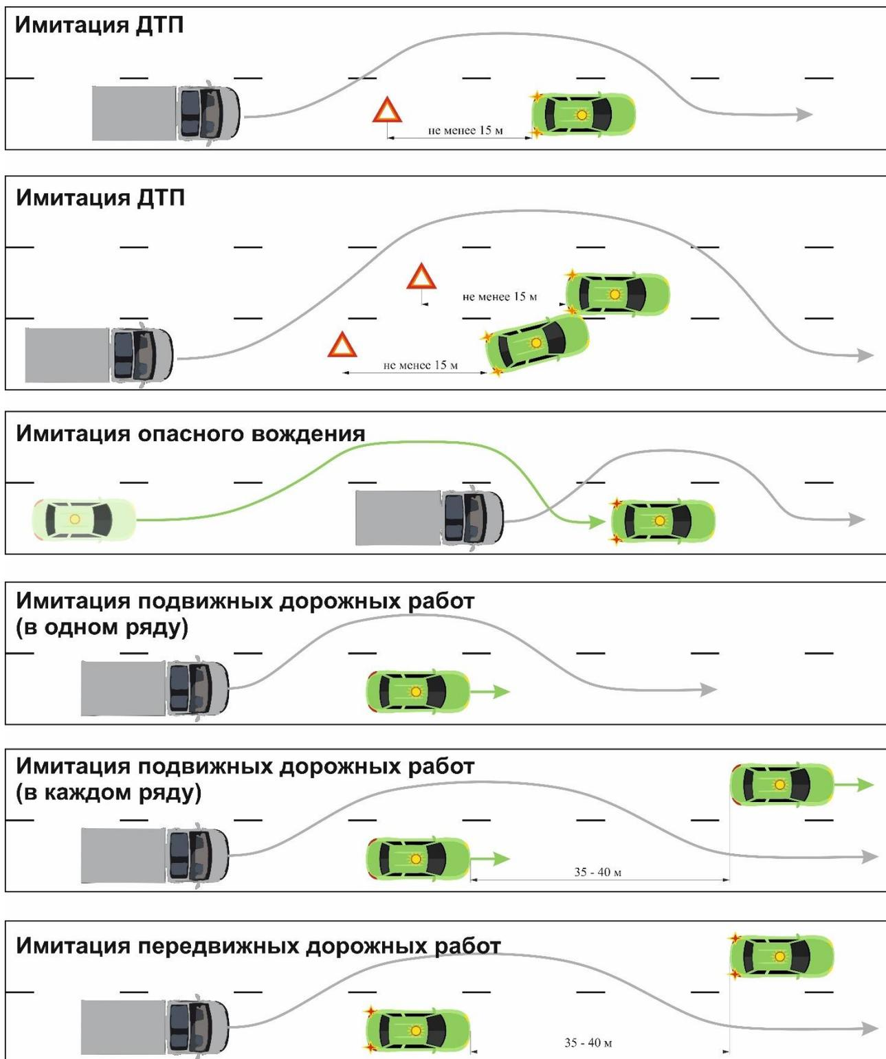
Рисунок 10 – Примеры и расположение препятствий на проезжей части
